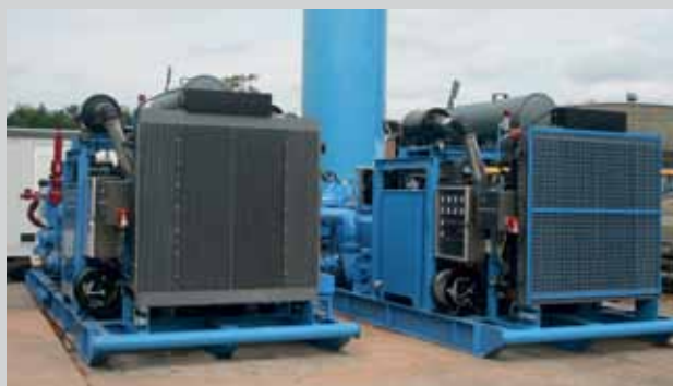
Насосные установки в рамном исполнении во время тестирования
