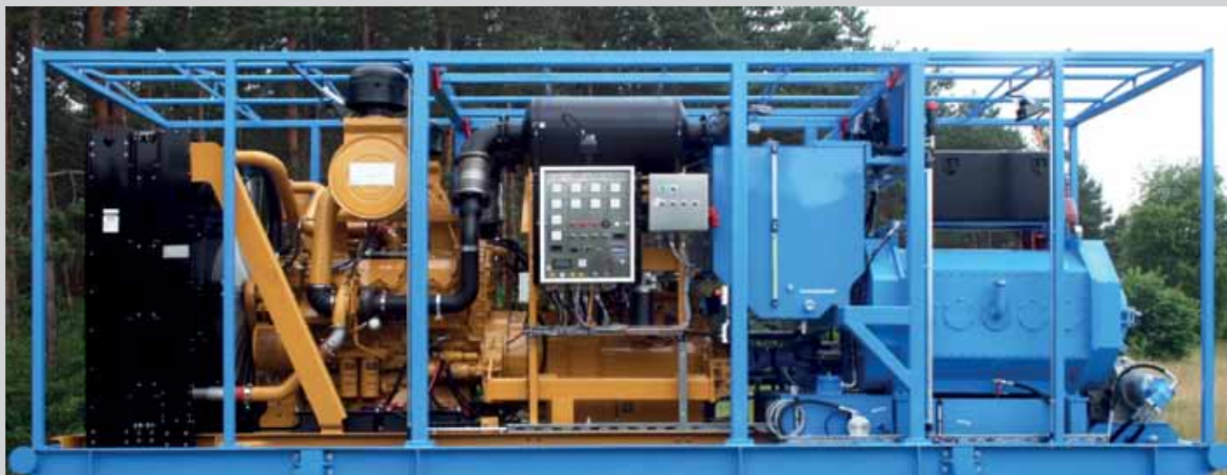
Насосная установка высокого давления в рамном исполнении с пятиплунжерным насосом
