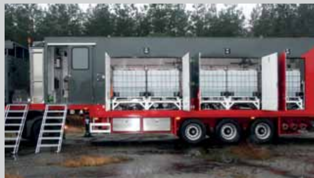
Установка хим добавок в термоизолированном фургоне
